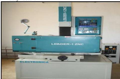
Fig. 2. Die Sinker EDM Model: PS 50ZNC
