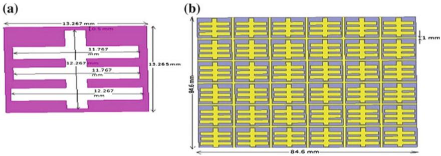
**Fig. 13** Slot-pair type FSS **a** Unit cell **b** 6 × 6 FSS
