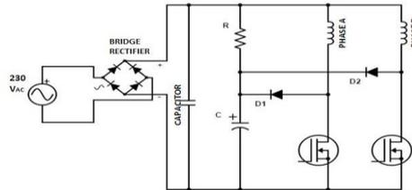
Fig. 10. R-Dump Converter
