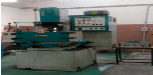
Fig. 1 Die sink EDM machine
