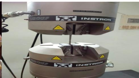
Fig. 4 Fatigue Test
