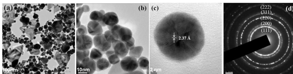
Figure 2. Study of morphology of Au NPs: (a, b) TEM, (c) HRTEM and (d) SAED pattern of Au NPs.
