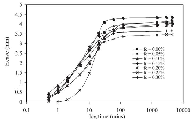
Fig. 1. Rate of heave ( $l=15$  mm).
