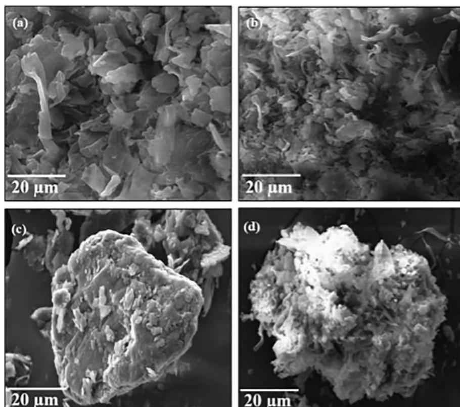
Fig. 1. SEM images of materials (a, b) Fungus, (c) GO, (d) GO-FH bio-nanocomposite material.
