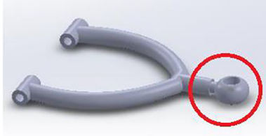
Fig. 3a. Upper A-arm (retracted).
