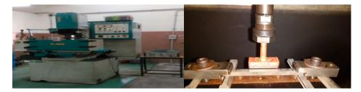
Fig. 1 Die sink EDM machine
