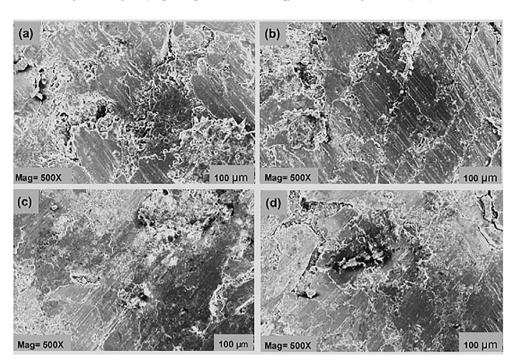
Fig. 8. SEM micrographs showing the worn surfaces of (a)  $C_0$  (b)  $C_1$  (c)  $C_2$  (d)  $C_3$ .
