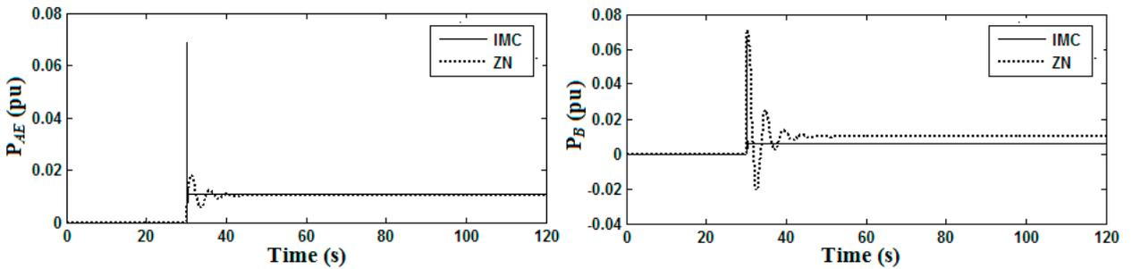
Fig. 4. (c) Power output of AE; (d) Power output of BESS.
