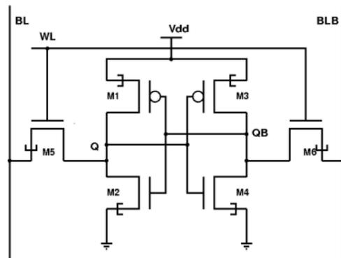
FIGURE 7. 6T TFET SRAM cell.
