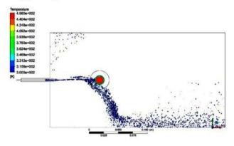
(d) Temperature contour for 150 ml/h flow rate
