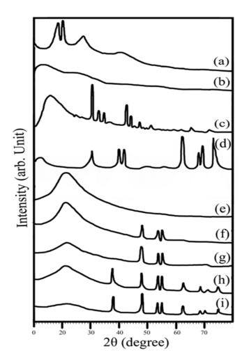
**Figure 3.1** XRD patterns of pristine material (a)PVdF- HFP(b)PMMA (c)  $LiClO_4$  (d)  $TiO_2$  and (e-i) composite polymer electrolytes PVdF-HFP(17.25)-PMMA(5.75)- $LiClO_4(8)$ -EC(69)- $TiO_2(X)$  [X= 0 (e), 5 (f), 10 (g), 15 (h) and 20 (i)]
